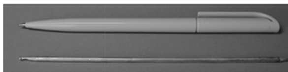
Mini copper-water heat pipe with OD 3.0 mm
